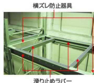
写真：落下防止を施した、パレット保管設備
